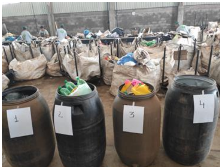
Figura 31- Realização do preenchimento das 04 bombonas com as sacolas de resíduos para o estudo da composição gravimétrica dos resíduos do município de TBP
