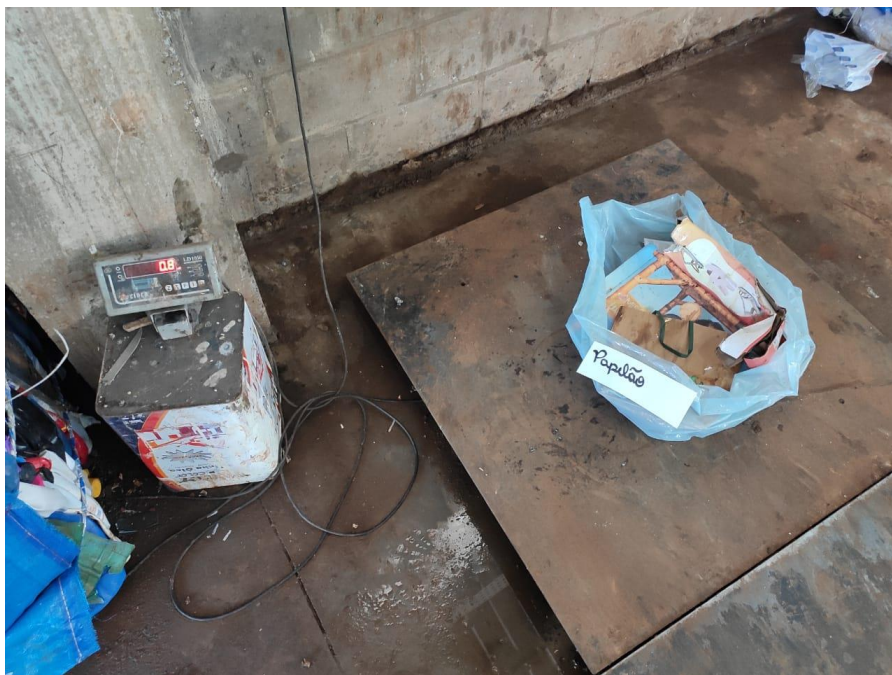
Figura 35-Pesagem de resíduos em balança digital, segundo sua tipologia, para o estudo da composição gravimétrica dos resíduos do Município de Três Barras do Paraná-PR.
