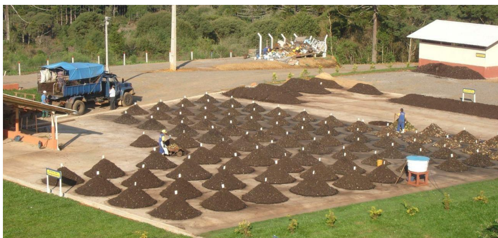
Figura 44-Exemplo de sistema de compostagem em leiras no município de Bituruna – PR.
